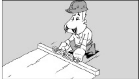
A falta de plomada otro método de controlar el aplomado es con un nivel de mano de mínimamente 60 cm de largo apoyado sobre una regla metálica de 2.50 m de longitud para lograr mayor precisión en la verificación; controlar con el indicador a burbuja que se encuentra en uno de los extremos del nivel de mano.
