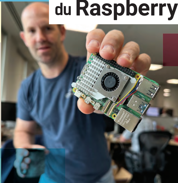
▲ Eben Upton tenant en main un prototype du système de refroidissement Active Cooler.
