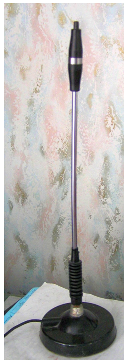
Рис. 1.4. Антенна с подстроечной катушкой и регулируемой длиной штыря на магнитном основании
