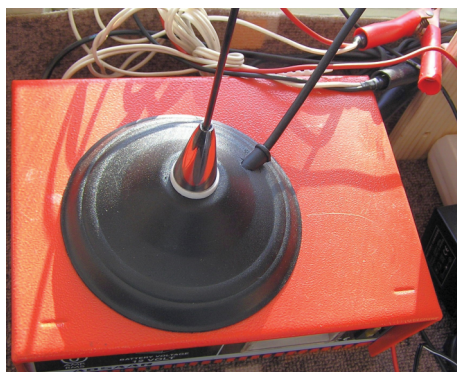
Рис. 1.1. Антенна для Си-Би-связи «Радуга-связь 27» на магнитном основании
