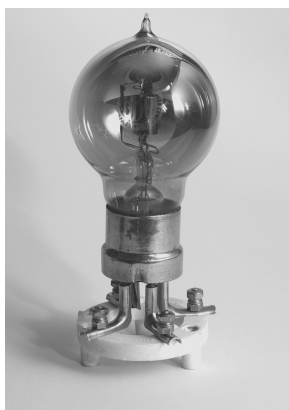
Рис. 1.1 Лампа R-типа, видны следы потемнения на колбе. (Вытравленная надпись утверждает, что эта лампа является «Типом, одобренным главным почтмейстером Би-би-си»)
