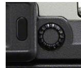
▲ Das Dioptrieneinstellrad ermöglicht das Anpassen des Suchers an die Sehkraft (Foto: Sony).
