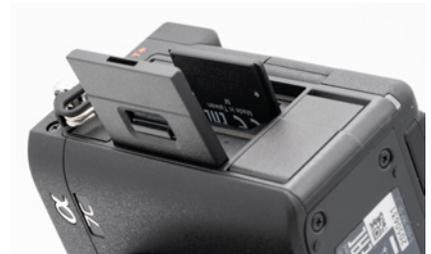
▲ Führen Sie die SD-Karte mit den Kontakten voran und der bedruckten Seite in Richtung Objektiv ein, bis Sie ein Klicken hören.
