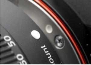
▲ Um ein Objektiv zu montieren, müssen Sie den weißen Punkt an diesem und den am Bajonett übereinandersetzen und das Objektiv im Uhrzeigersinn drehen.
