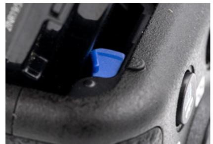
▲ Die blaue Akkuverriegelung muss mit dem Akku zur Seite gedrückt werden, damit Sie diesen einführen können.
