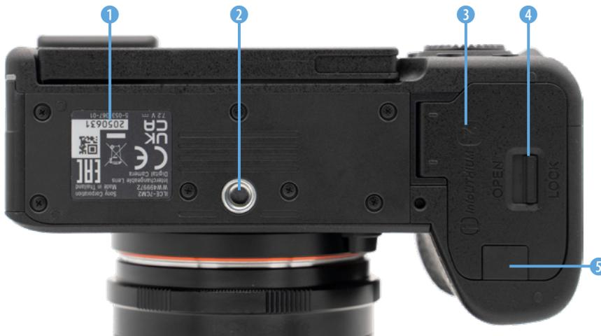
◀ An der Unterseite finden Sie unter anderem den Einschub für den Akku und ein Stativgewinde.
