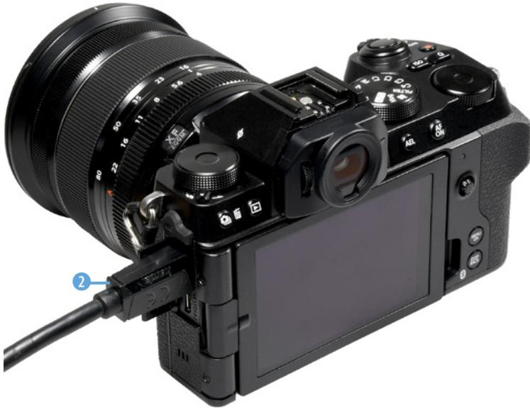
◀ Laden Sie den Akku zum Beispiel mit einer Powerbank oder einer Verbindung zu einem Rechner auf.
