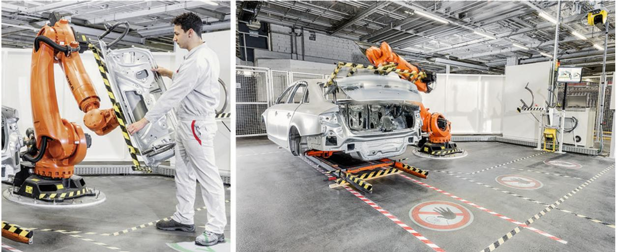
**Bild 1.7** MRK-Heckklappenmontage bei AUDI AG (Quelle: Audi AG)
