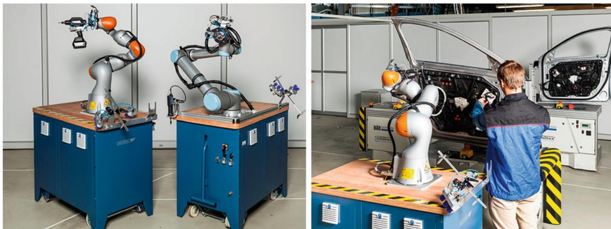
**Bild 1.9** Entwicklung einer mobilen Türmontagestation mit einem MRK-Robotersystem (Quelle: ARENA2036/Rainer Bez)
