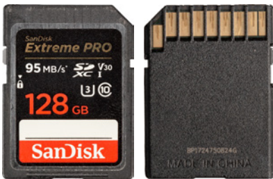
▲ SD-Karten des Standards UHS-I besitzen eine Reihe an Kontaktflächen. Die maximale Schreibgeschwindigkeit beträgt 104 MB/Sek.
