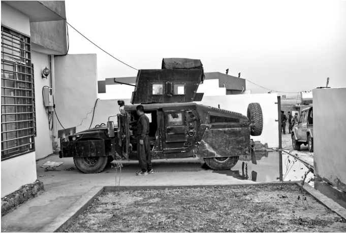
Ein Humvee-Geländewagen der US-Armee mit improvisiertem Raderschutz und einem Geschützturm mit sowjetischem DschK-Maschinengewehr.
