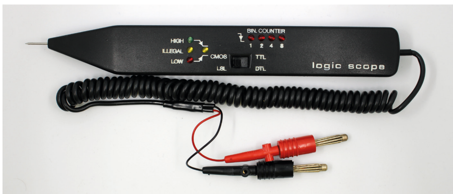
Bild 1.7 Ein Logic Scope aus den 1980er Jahren welches auch binär zählen kann
