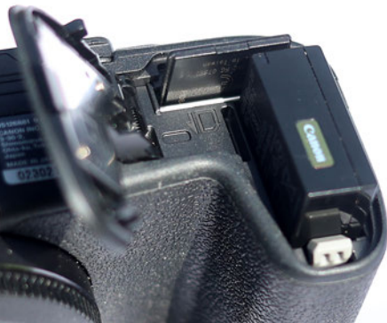
Abb. 1.7 Der Kartenschacht und die Aufnahme für den Akku befinden sich hinter der Klappe auf der Unterseite der Kamera. (Foto: Canon)
