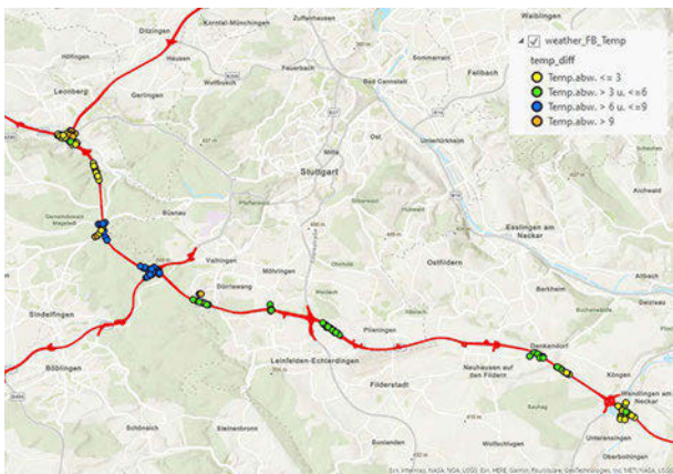
Abb. 7: Fahrbahntemperatur (22.01.2023, 8:00–8:15 Uhr, Messwerte im Umkreis von SBA-Sensoren)
