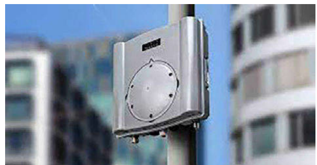
Abb. 2: Beispiel für eine RSU (Quelle: Yunex Traffic)
