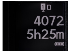
▲ Ist die Kamera ausgeschaltet, informiert das Informationsdisplay für wie viele Fotos und Videos der Speicherplatz ausreicht und über den Ladezustand des Akkus.
