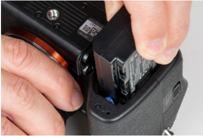
▲ Beim Einlegen in den Akkuschlacht wird der blaue Verriegelungshebel mit der Seite des Akkus hineingedrückt.
