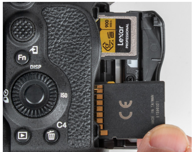
▲ Jeder Steckplatz kann jeweils entweder eine CFexpress-Typ-A-Karte oder eine SD-Karte aufnehmen. SLOT1 ist der obere und SLOT2 der untere Steckplatz.
