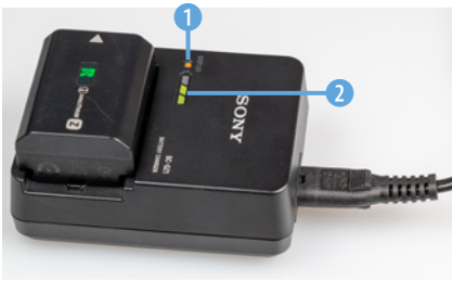
▲ Ladegerät mit einem zu 60 %-90 % vollgeladenen Akku (zwei grüne Teilstriche).
