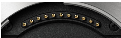
▲ Kamera und Objektiv kommunizieren über diese Kontakte am Bajonett (Foto: Nikon).
