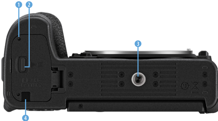
◀ An der Unterseite finden Sie unter anderem den Einschub für den Akku und ein Stativgewinde (Foto: Nikon).
