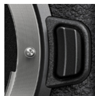
◀ Mit dieser Taste kann das Objektiv entriegelt werden, um es zu wechseln (Foto: Nikon).
