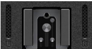
▲ Rechts und links vom Zubehörschuh befindet sich das Stereomikrofon (Foto: Nikon).
