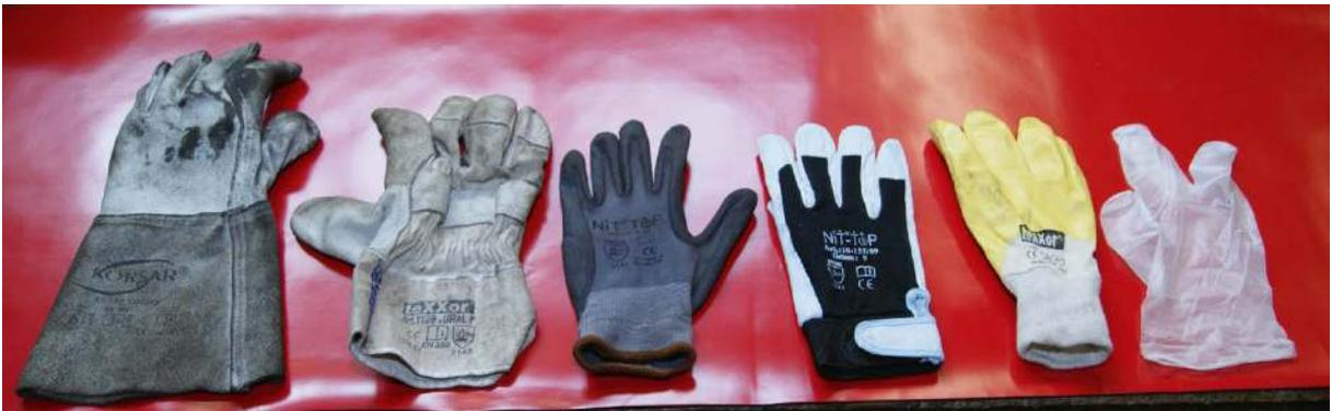
*Auswahl von Arbeitshandschuhen, die jeder Hobbyschrauber haben sollte. Von links nach rechts: Schweißerhandschuh mit hoher Stulpe, Lederhandschuh für grobe mechanische Arbeiten, Gummierter Textilhandschuh für mechanische Arbeiten an ölerschmierten Teilen, Textilhandschuh mit Lederverstärkung für feine mechanische Arbeiten. Kunststoffhandschuh für den Umgang mit Betriebsflüssigkeiten, dünner Chemikalien-Schutzhandschuh.*
