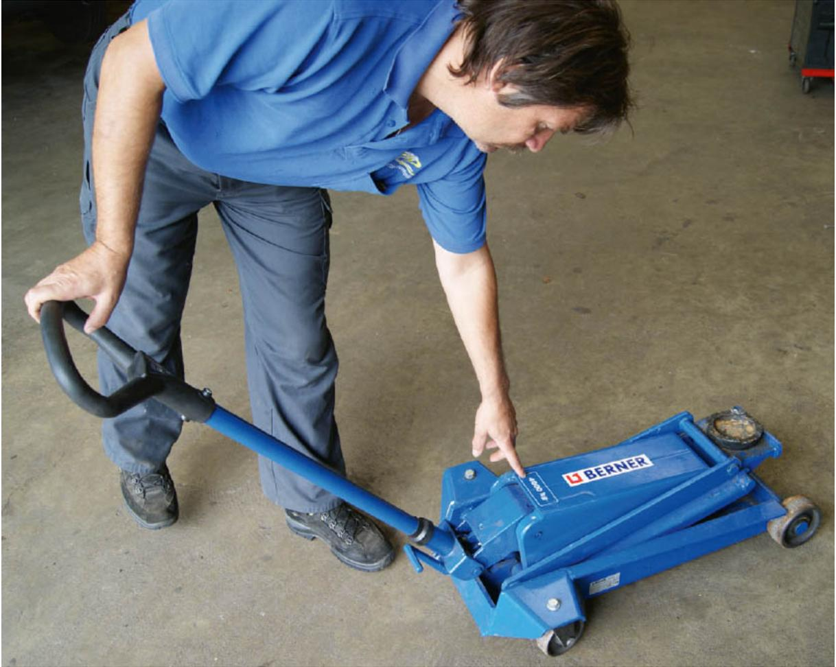
*Mit 4000 Kilogramm Tragkraft ist dieser Lkw-Wagenheber völlig ausreichend für Traktoren.*
