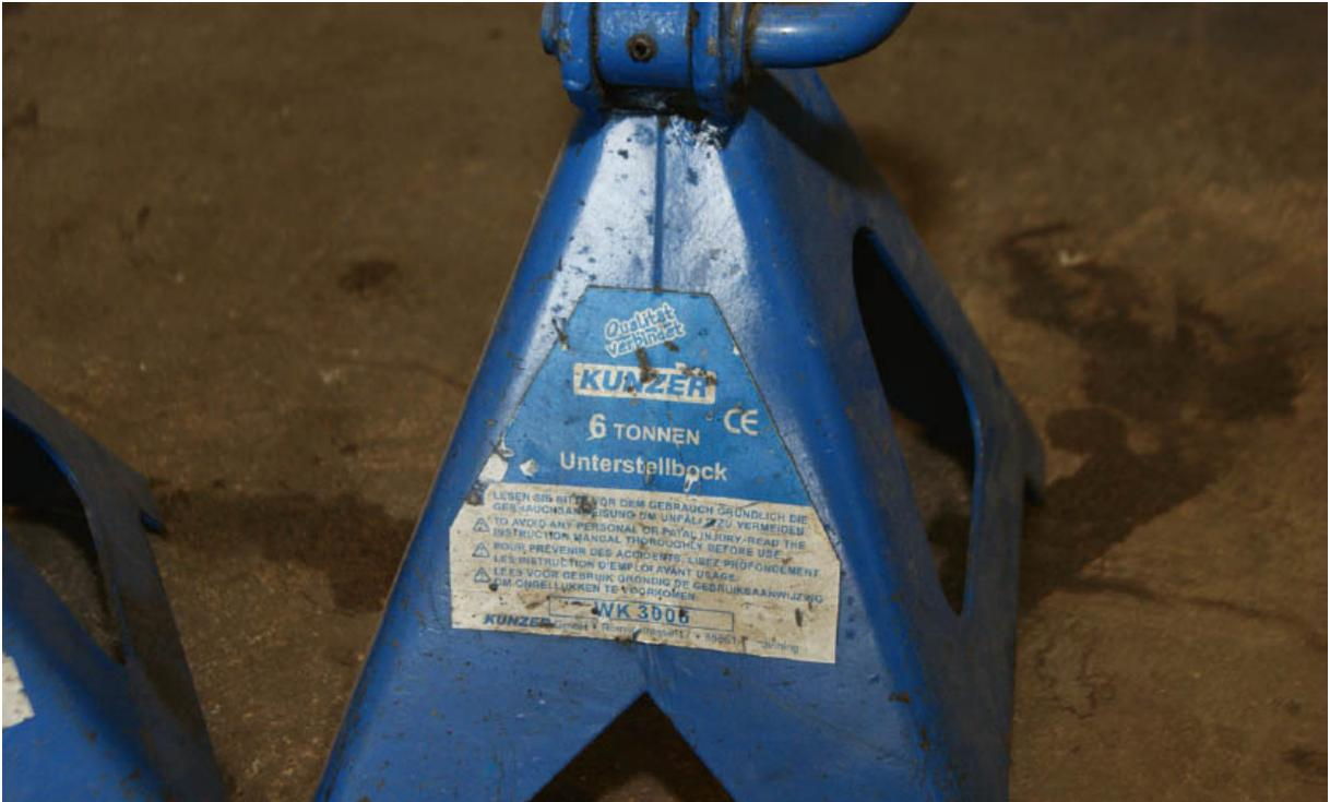
*Für die Sicherung des Wagenhebers sind Lkw-Stützböcke ideal. Pkw-Stützböcke sind den hohen Traktorgewichten nicht gewachsen.*
