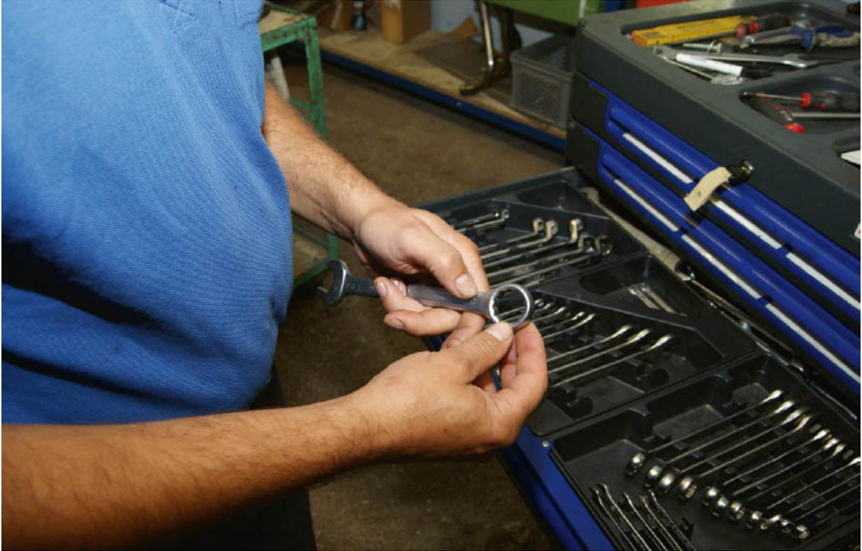
*von oben nach unten: Eine raue Oberfläche garantiert einen sicheren Griff – auch wenn das Werkzeug överschmiert ist.*
