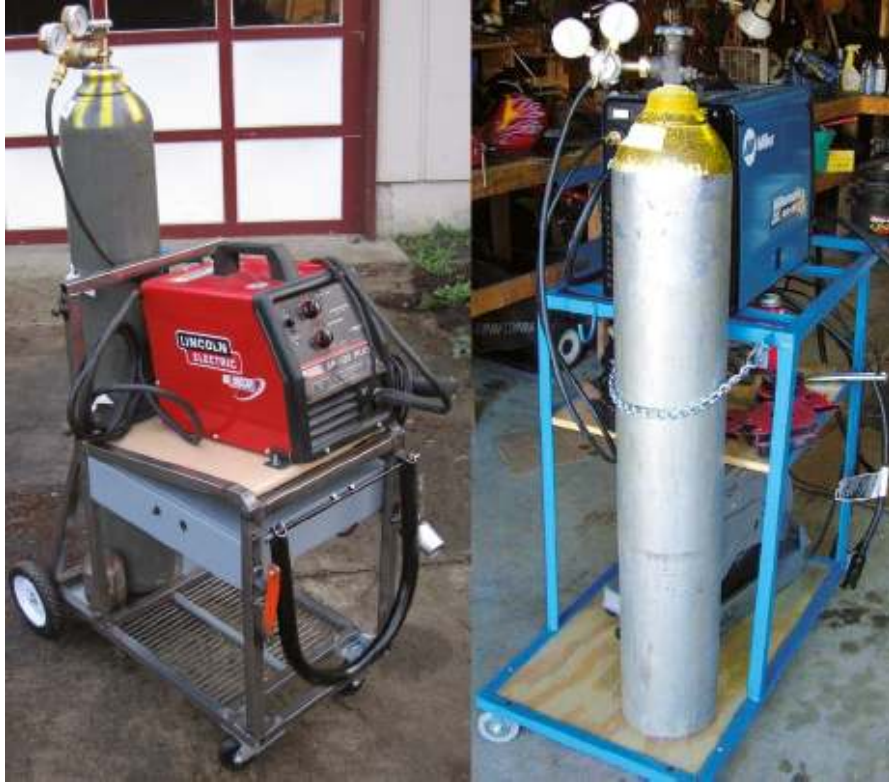
A la izquierda, una botella de gas para soldadura MAG (cuello pintado de amarillo y gris); a la derecha, una para soldadura MIG (cuello pintado solo de amarillo).
