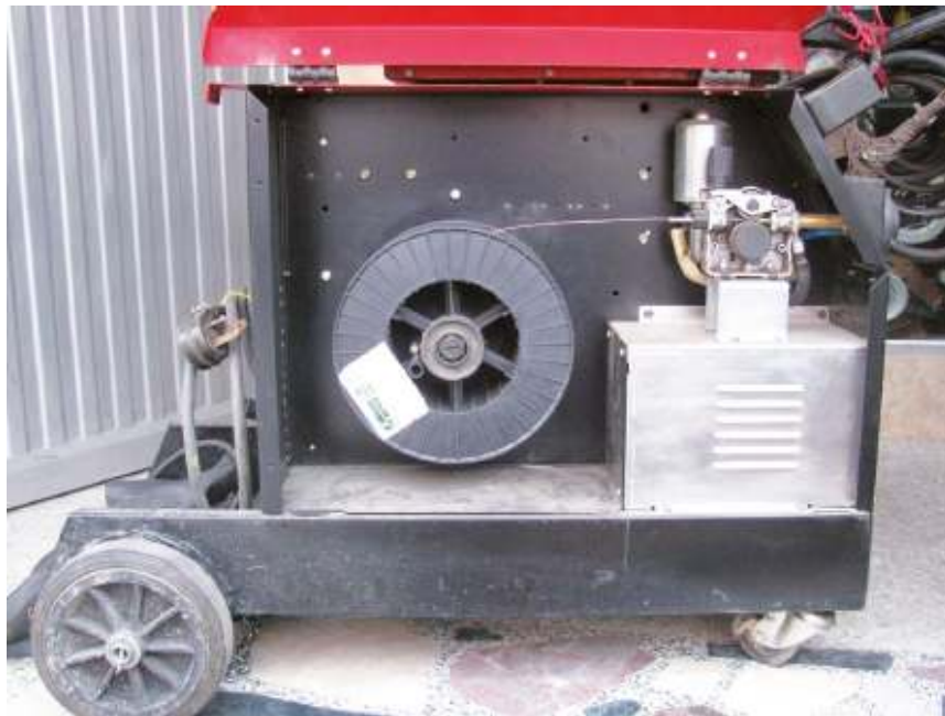
Rollos de alambre para equipo MIG
