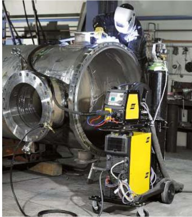
Cordones de gran longitud con soldadura MIG
