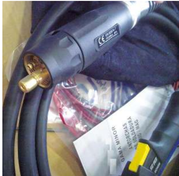
Conector de antorcha para MIG/MAG con marcado CE
