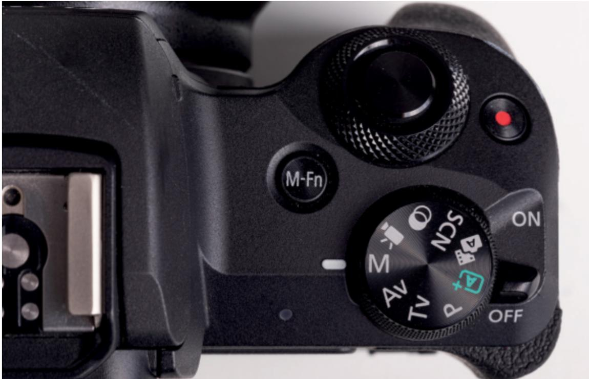
En muchas cámaras, existe una rueda con modos de exposición. El modo de exposición manual, en este caso señalado con la letra M, permite un mayor control al fotógrafo.
