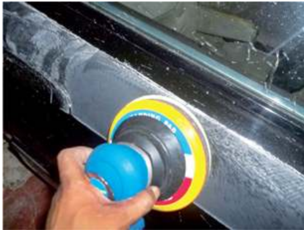
Lijado de bordes con disco abrasivo
