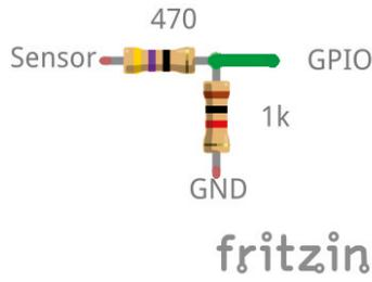
Abb. 4: Spannungsteiler mit zwei Widerständen
