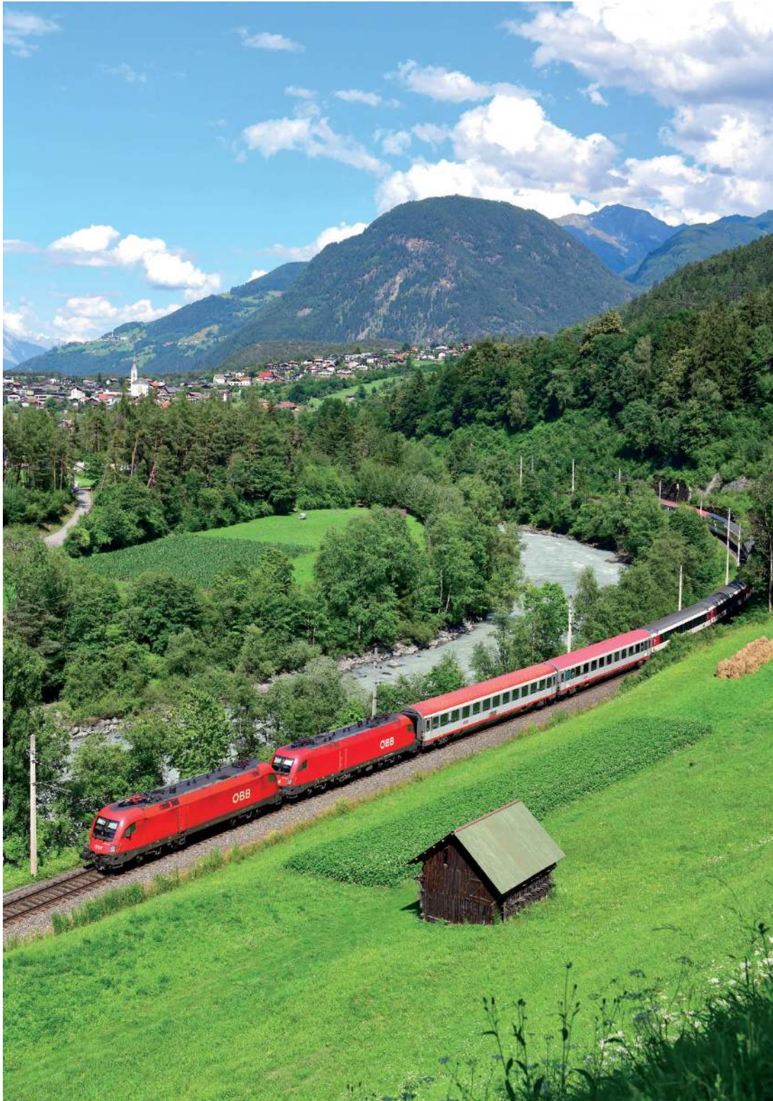
Der EC 164 wird im Abschnitt Innsbruck – Buchs wegen der Steigungen der Arlbergbahn von einem Tandempaar geführt: 1016.035 und 1016.010 passieren am 10. Juli 2021 die Innschlucht bei Roppen.
