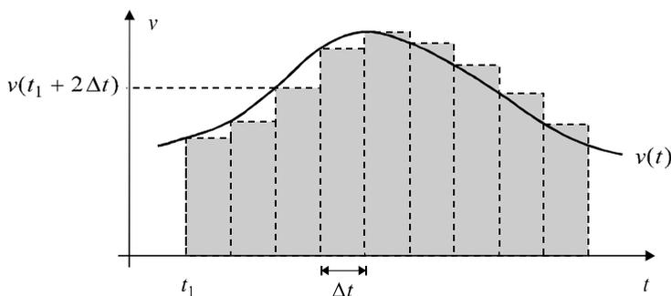
**Abb. 2.3–2** Der gesamte Weg ist die Summe der Teilwege. Für kleine  $\Delta t$  ist jeder Teilweg ungefähr gleich der Geschwindigkeit am Anfang des Teilweges mal  $\Delta t$ .
