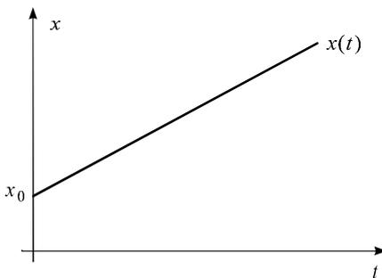
**Abb. 2.2–1** Orts-Zeit-Diagramm einer gleichförmigen Bewegung
