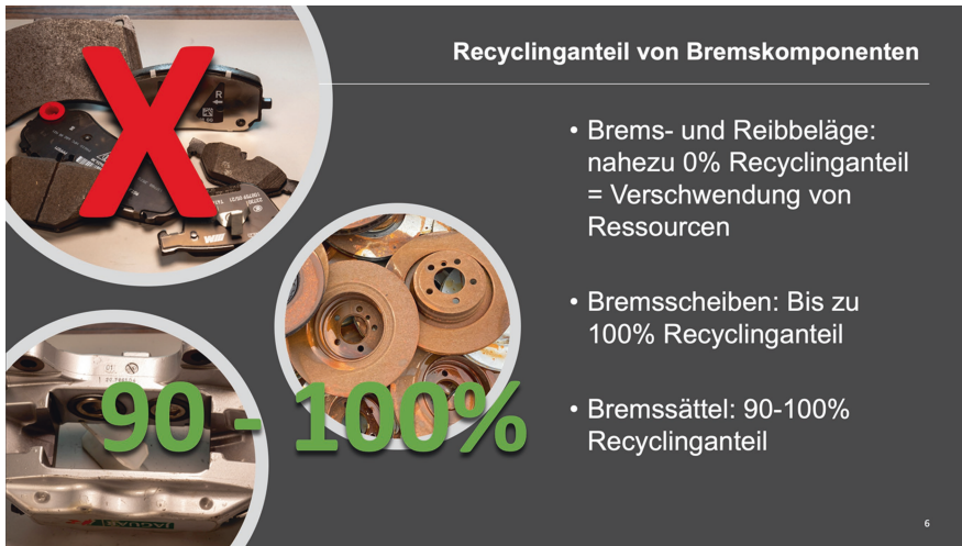
Abb. 1. Am Beispiel der Scheibenbremse lässt sich gut verdeutlichen wie sehr sich die Recyclingquoten der drei Bremskomponenten Scheibe, Sattel und Belag unterscheiden [19]
