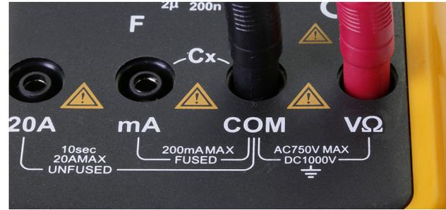
Abbildung 1–20. Verschiedene Messgeräte, gleiche Lage der Messbuchsen
