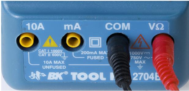
Abbildung 1–19. Stecke die Messleitungen in diese Buchsen.
