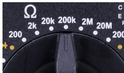
Abbildung 1–23. Bei einem Multimeter mit manueller Bereichswahl musst du den Bereich selbst einstellen.
