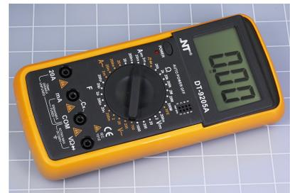
**Abbildung 1–3.** Ein Messgerät mit manueller Bereichswahl
