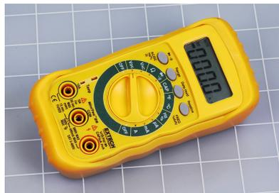
**Abbildung 1–2.** Ein Messgerät mit automatischer Bereichswahl
