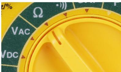
Abbildung 1–22. Einen Autorange-Multimeter auf Widerstandsmessung einstellen
