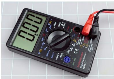
**Abbildung 1–1.** Ein einfaches digitales Multimeter. Die Linien auf dem untergelegten Papier haben einen Abstand von 1 Zoll (2,54 cm).
