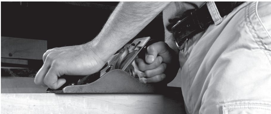
Foto 6: Hobeln – in der Mitte des Stoßes. Man übt gleichmäßigen Druck auf beide Griffe aus.
