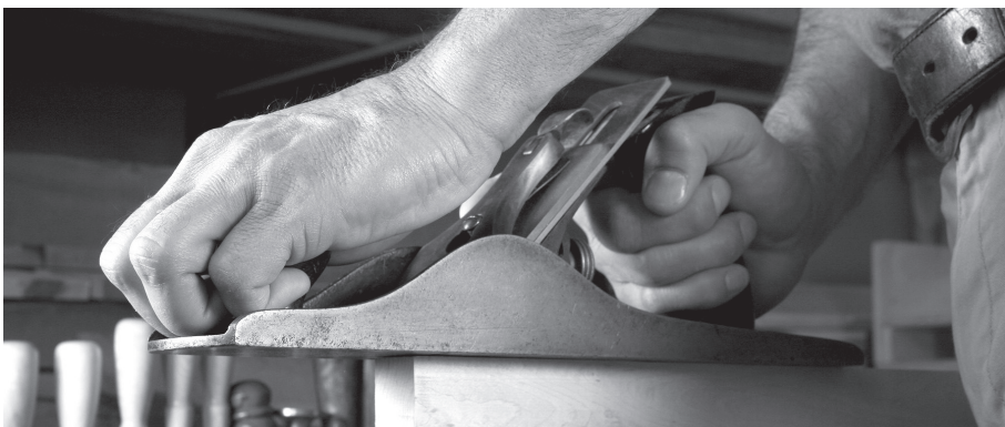
Foto 7: Hobeln – Der Hobelstoß wird mit kräftigem Druck nach unten auf den hinteren Griff beendet.
