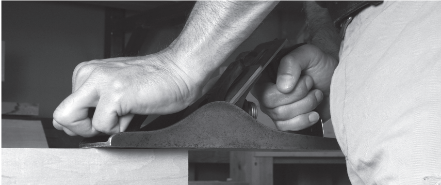
Foto 5: Hobeln – Der Anfang des Hobelstoßes. Man übt vorne auf den Knopf kräftigen Druck nach unten aus.
