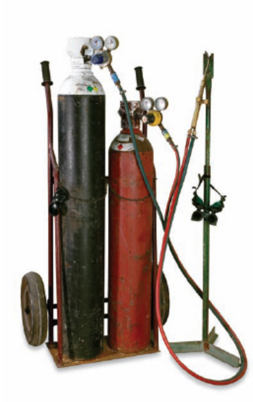
Botellas de almacenamiento del oxígeno (negra) y del gas acetileno (roja).
