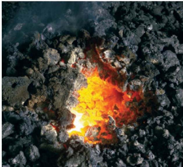
Bóveda de carbón conseguida al rociar las brasas con agua.
