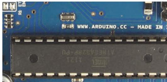
**Figura 2.4.** Microcontrolador ATmega328.
