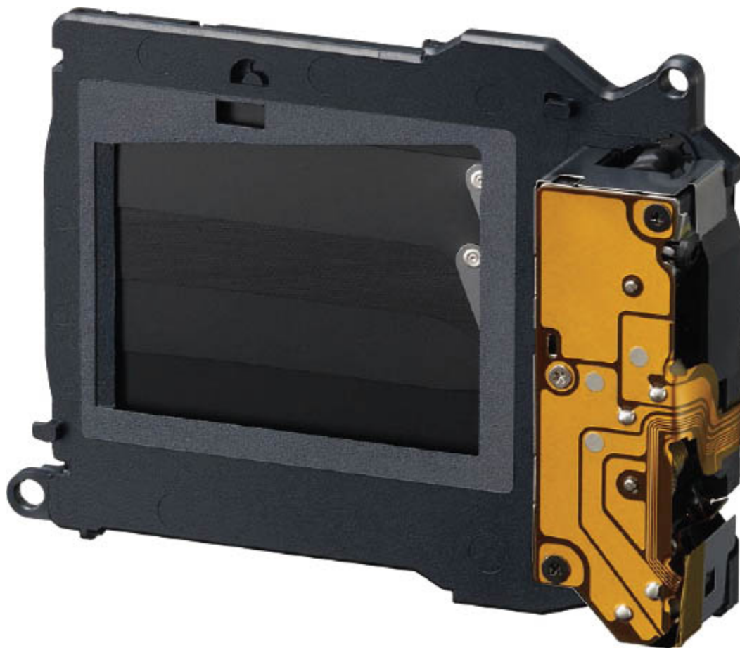
Abb. 1.4 Verschluss der \alpha 7 IV (Foto: Sony)
