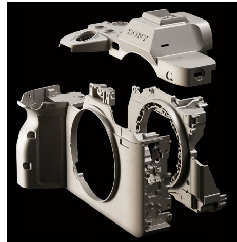
Abb. 1.5 Das Gehäuse der \alpha 7 IV besteht zum großen Teil aus einer Magnesiumumlegierung und ist gegen Feuchtigkeit und Staub geschützt (Grafik: Sony).
