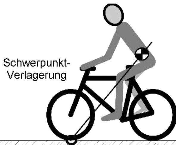
Abb. 2.3: Reduktion der Überschlaggefahr beim Bremsen.
