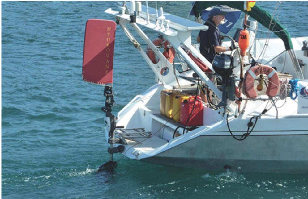
Système de gouvernail auxiliaire Hydrovane sur un Ovni 435
