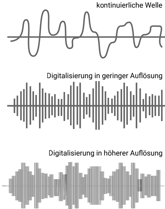
Abb. 1.4: Vereinfachte Darstellung der digitalen Verarbeitung einer kontinuierlichen Schallwelle: je enger die Zahl der Einzelschritte pro Abschnitt, desto geringer der Qualitätsverlust der Darstellung. Mit jeder Erhöhung der Einzelschritte nimmt die Qualität der Wiedergabe zu. Gegenüber der kontinuierlichen Darstellung ist ein Qualitätsverlust durch Digitalisierung unvermeidbar.
