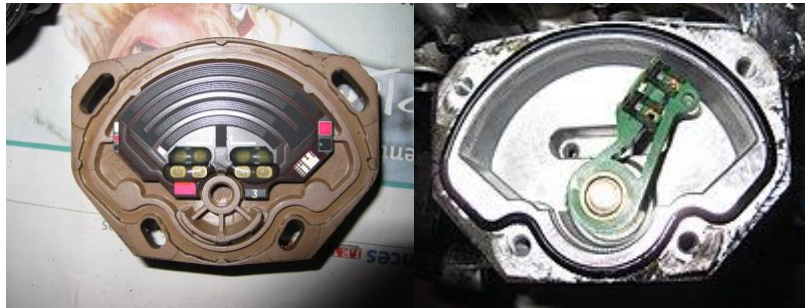
Figura 2.5. Izquierda: Sensor de posición de válvula mariposa Fuente: https://en.wikipedia.org/wiki/Throttle_position_sensor#/media/File:Throttle_position_sensor_-_2.jpg Derecha: Pista de material resistivo y contacto deslizante. Fuente: https://en.wikipedia.org/wiki/Throttle_position_sensor#/media/File:Throttle_position_sensor_-_1.jpg
