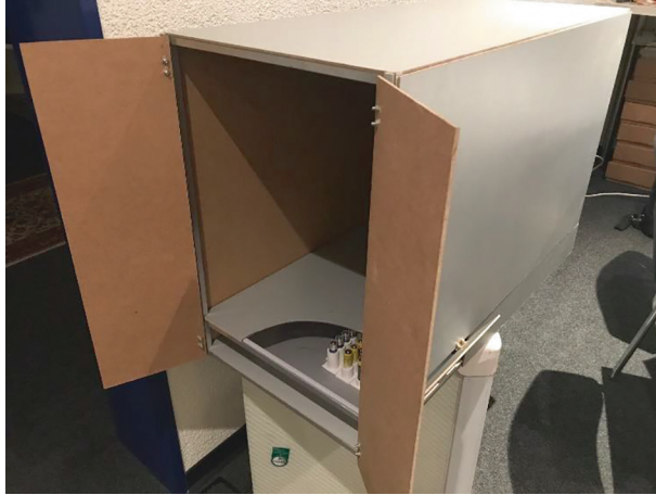
Erhardt Model, selbsttragende Cargobox mit Akku-Einhausung und Schubladenfach
