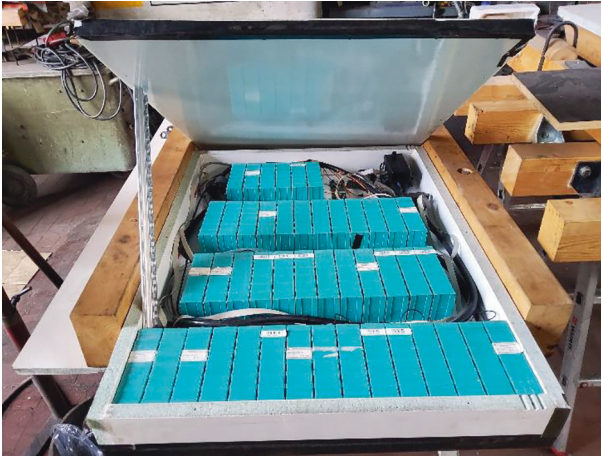
Isogehäuse/Schublade für Akku-Packages im Nutzfahrzeug-Unterbau integriert
