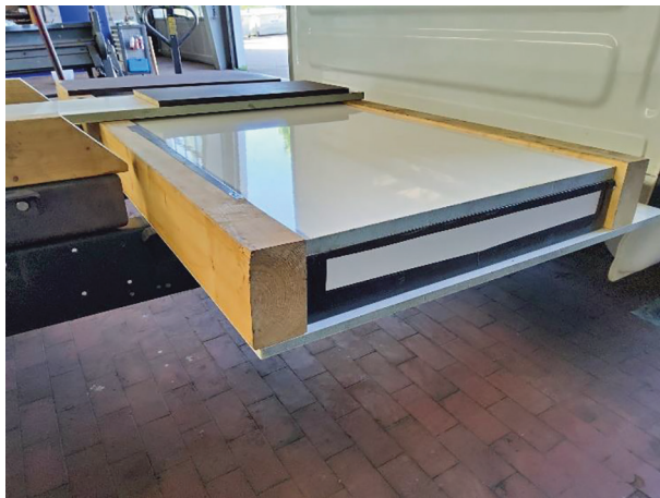
Isogehäuse/Schublade für Akku-Packages im Nutzfahrzeug-Unterbau integriert
