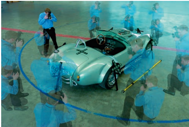
Bild 2: Photogrammetrische Einmessung von Passpunkten (oben) und anschließende Aufnahme mit dem Streifenprojektionssystem GOM ATOS (unten) (Quelle: GOM).
