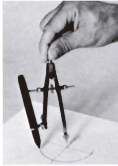
Fig. 3.16 El portaplu-mas-fuente puede emplearse en el compás con ayuda de adaptadores especiales
