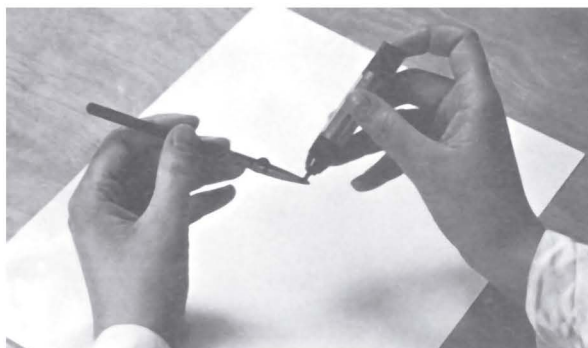
Fig. 3.10 Al cargar el tiralíneas, se deja que la gota salte partiendo de la punta del mismo
