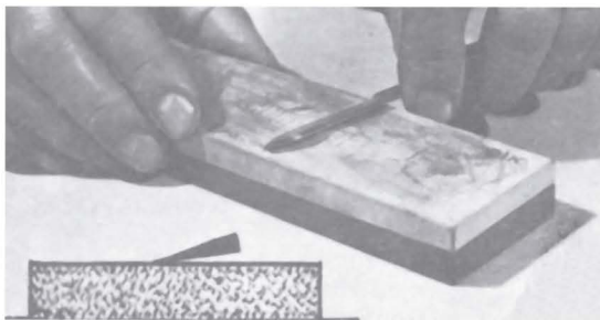
Fig. 3.23 Durante el afilado no se levanta sino ligeramente el canto opuesto de la hoja.
