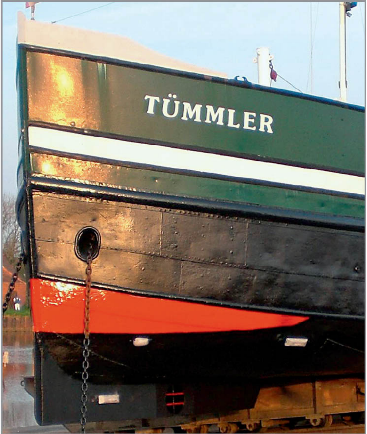
Abbildung 1-6: Opferanoden aus Zink oder Magnesium werden anstatt des Rumpfes abgetragen.
