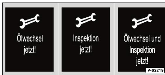
Bei Erreichen der vom Steuergerät berechneten Intervalldauer ertönt beim Einschalten der Zündung ein akustisches Signal und im Display des Kombiinstruments wird ein Schraubenschlüssel-Symbol
