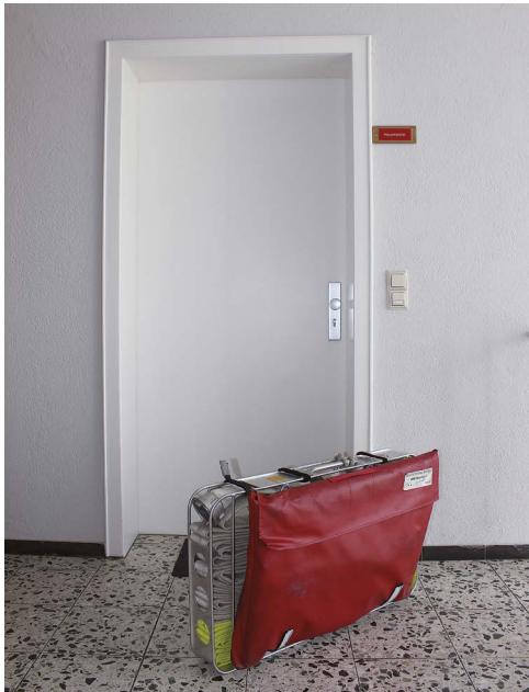
Bild 1.2 Beispiel für die schadenarme Einsatztaktik: Ein Mobiler Rauchverschluss wird am Schlauchtragekorb mitgeführt und kann so vor dem Eindringen in die Wohnung zur Verhinderung einer unkontrollierten Rauchausbreitung in den Treppenraum schnell montiert werden.
