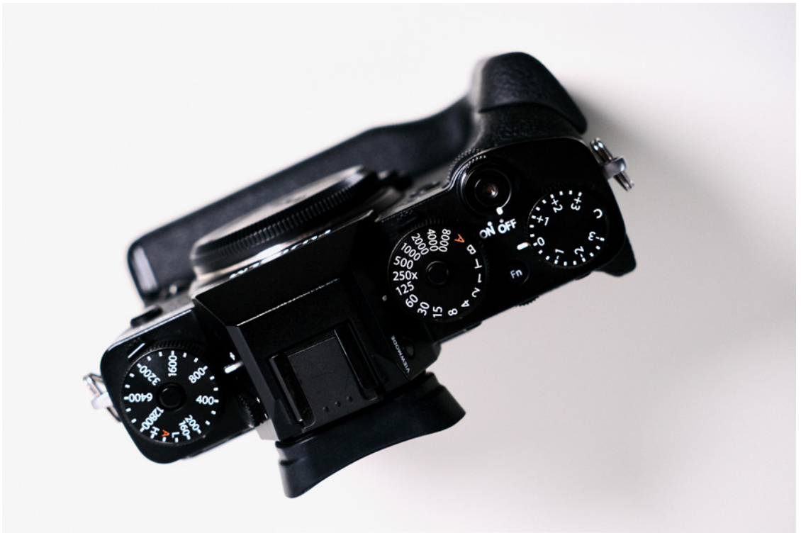
▲ Die Fujifilm X-T3, hier ohne Objektiv, aber dafür mit gutem Blick auf die analog anmutenden Bedienräder für ISO und Verschlusszeit. Am Objektiv würde sich noch der Blendenring finden.
