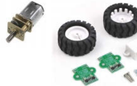
Abb. 1.14: Getriebemotor plus Reifen und Encoder
