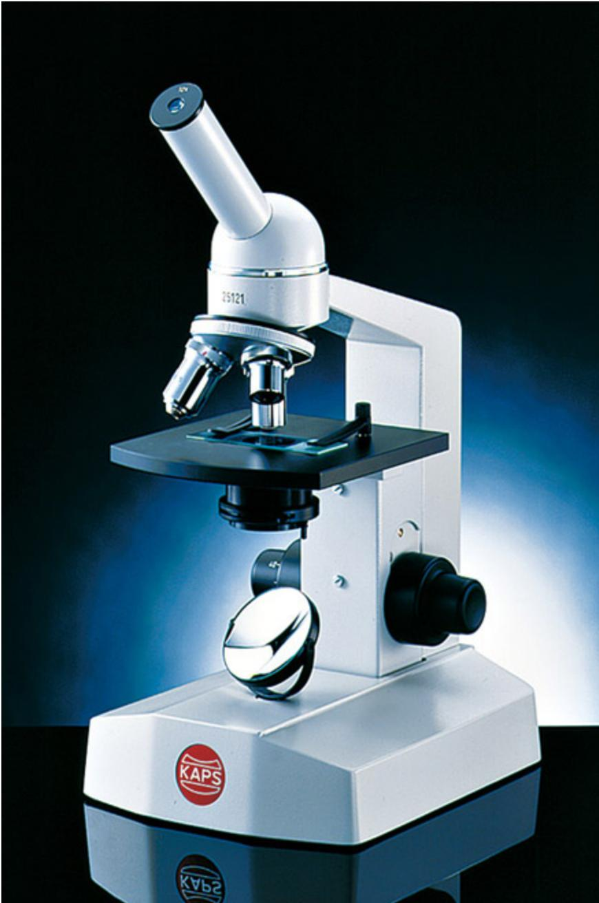
Schul- und Kursmikroskop mit koaxialem Grob- und Feintrieb und Kondensator. Der Spiegel kann durch eine Aufsteckleuchte ersetzt werden.
