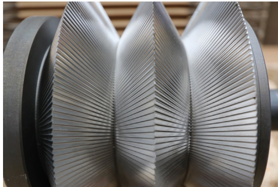
Abb. 1.15: Prinzip Keilscheibenmühle, T-Rex by Ziemann® [1.17]
