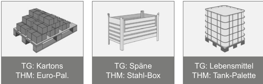
**Abb. 2.2** Beispiele für Transporteinheiten, bestehend aus einem Transportgut (TG) und einem Ladehilfsmittel (LHM)
