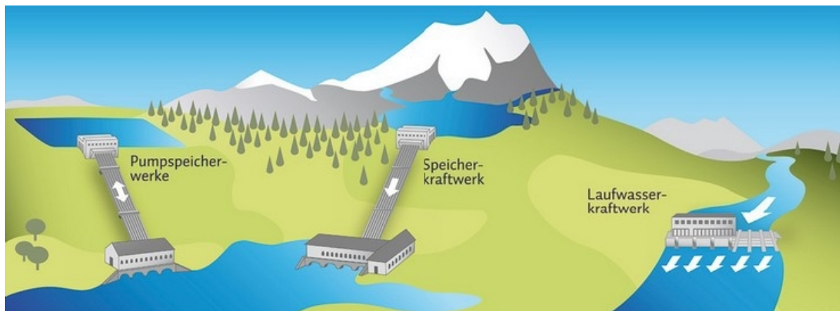
Bild 3. Möglichkeiten, Wasserkraft in CO 2 -freien Strom umzuwandeln
