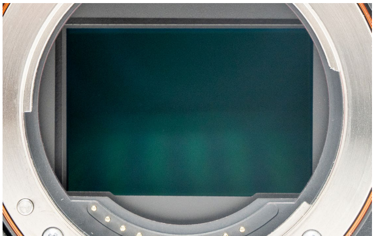
Abbildung 1.1: Bildsensor der \alpha 7C (Bild: Sony)
