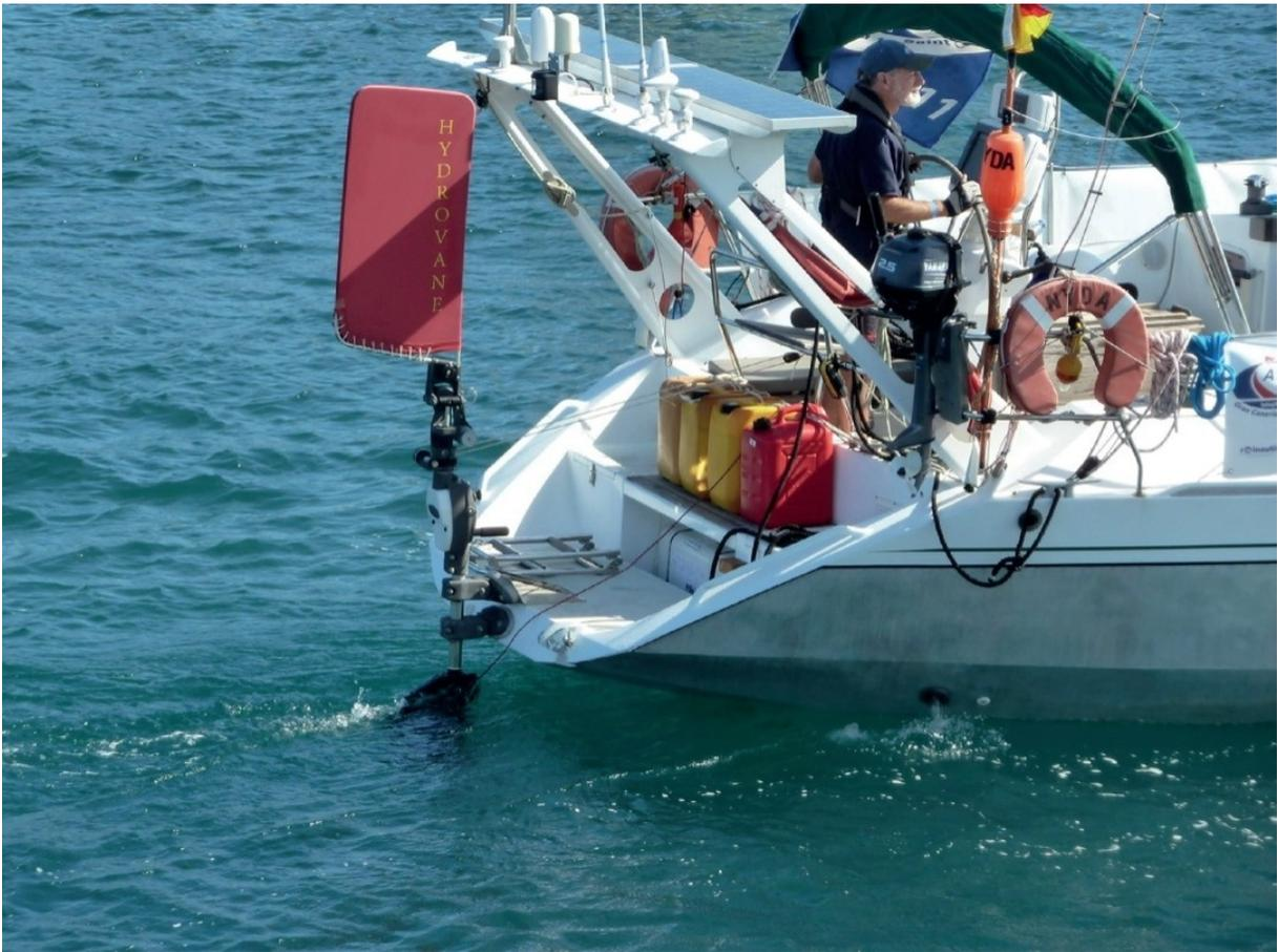
Hilfsrudersystem Hydrovane an einer Ovni 435
