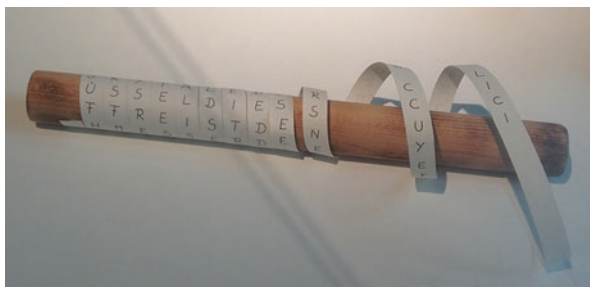
Abb. 2.1 Die Skytale ist das älteste bekannte Verschlüsselungsgerät. Man schreibt die zu verschlüsselnde Nachricht auf einen Papierstreifen, der um einen runden Stab gewickelt ist. (Klaus Schmeh)
