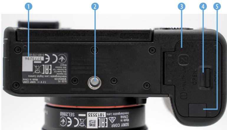
◀ An der Unterseite finden Sie unter anderem den Einschub für den Akku und ein Stativgewinde.
