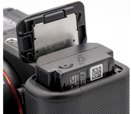
▲ Der Energiespeicher muss mit den Kontakten voran und der bedruckten Seite vom Objektiv weg eingeschoben werden.
