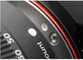
▲ Um ein Objektiv zu montieren, müssen Sie den Punkt am Objektiv und den am Bajonett übereinandersetzen und im Uhrzeigersinn drehen.
