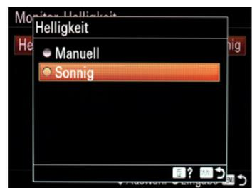
▲ Nutzen Sie die Einstellung **Sonnig**, wird das Display immer maximal hell sein. Dies kann zu einer Fehlbeurteilung führen.
