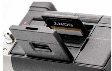
▲ Führen Sie die SD-Karte mit den Kontakten voran und der bedruckten Seite in Richtung Objektiv ein, bis Sie ein Klicken hören.
