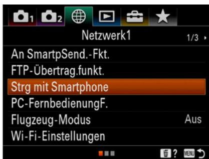
▲ Im Netzwerkmenü finden Sie alles rund um die drahtlosen Verbindungen, so zum Beispiel die Steuerung der Kamera mit dem Smartphone.
