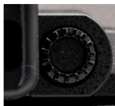
▲ Das Dioptrieneinstellrad ermöglicht das Anpassen des Suchers an die Sehstärke.
