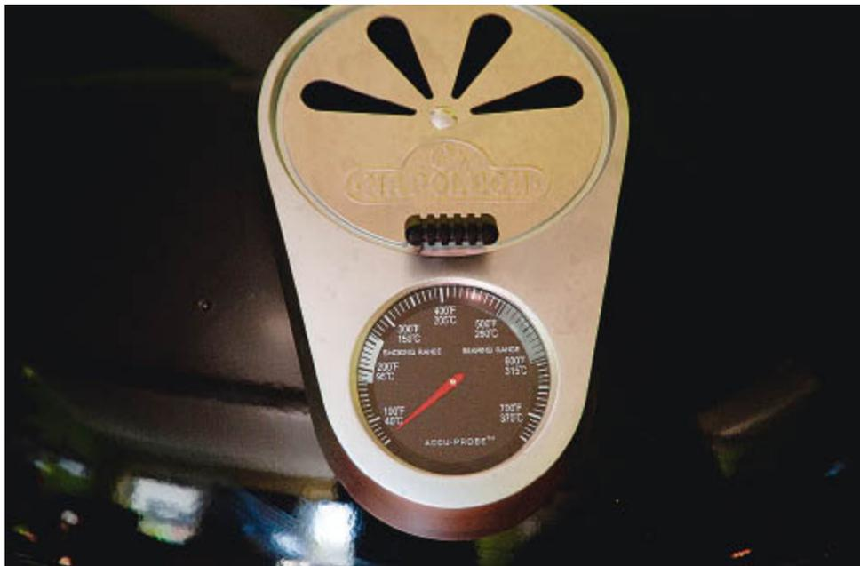
Sollte die Kohle zu heiß geworden sein, die Sauerstoffzufuhr im Grill drosseln. Mit diesem System der regulierten Luftzufuhr können erfahrene Griller den Holzkohlegrill fast auf das Grad genau steuern. Es ist Übungssache, mit der verzögerten Reaktion des Abkühlens und Aufheizens von Holzkohle optimal umgehen zu können. Dabei sind auch Faktoren wie die Außentemperatur, die Qualität der Holzkohle und die Windverhältnisse zu berücksichtigen.
